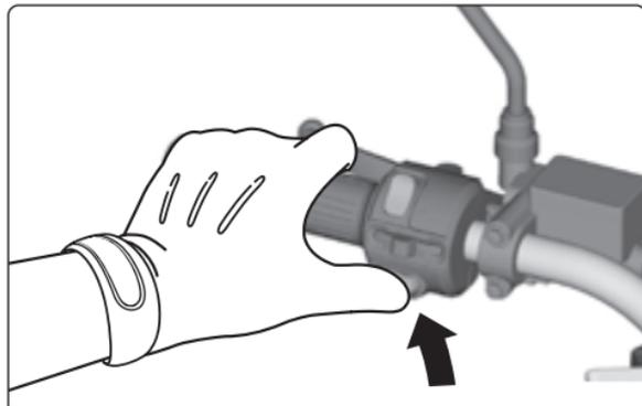
走行中にスポーツモードを起動するには、矢印のSスイッチを押してホールドします。スイッチから手を離すとスポーツモードは終了し、ノーマルモードに戻ります。
