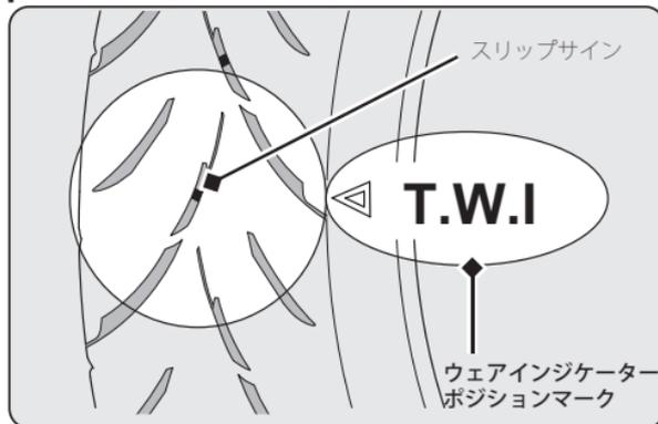
ウェアインジケーターを確認し、スリップサインが現れていたなら、磨耗限度なので新品タイヤに交換してください。
