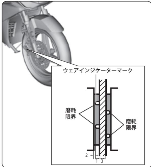
前後ブレーキパッドの磨耗状態を点検してください。パッドウェアインジケーターマークが見えないところまで磨耗していたら交換が必要です。
